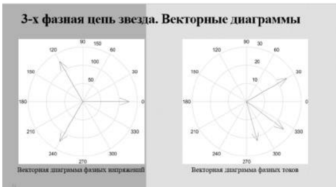
Рис. 2. Векторные диаграммы фазных токов и напряжений трехфазной цепи
